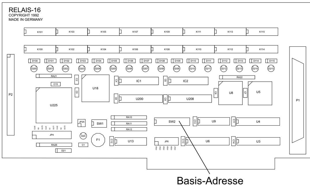
Die Interfacekarte RELAIS-16<sub>EXTENDED</sub> decodiert die Adressleitungen A4 bis A11. Für die Basis-Portadresse sind die Adressleitungen A4 bis A9 relevant, da in den PC's nicht der volle Adressbereich ausdecodiert wird. Die Dip-Schalter der Adressleitungen A10 und A11 müssen immer ON sein.
