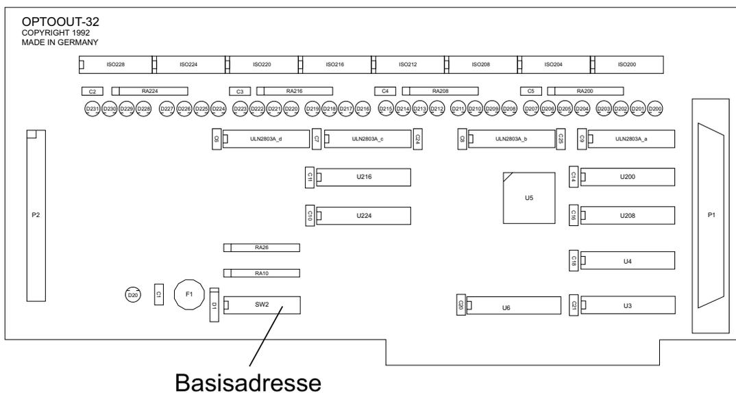
Die Interfacekarte OPTOOUT-32<sub>STANDARD</sub> decodiert die Adressleitungen A4 bis A11. Für die Basis-Portadresse sind die Adressleitungen A4 bis A9 relevant, da in den PC's nicht der volle Adressbereich ausdecodiert wird. Die Dip-Schalter der Adressleitungen A10 und A11 müssen immer ON sein.
