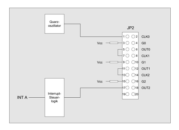
**Achtung:** Jumperverbindung 19/20 dient nur für interne Testzwecke und darf vom Anwender nicht gesetzt werden!
