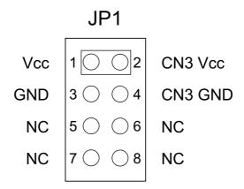
Durch Setzen der Jumper JP1/1-2 und 3-4 kann die interne Versorgungsspannung (+ 5V), sowie die Masse des Rechners auf den Wannenstecker CN3 gelegt werden.
