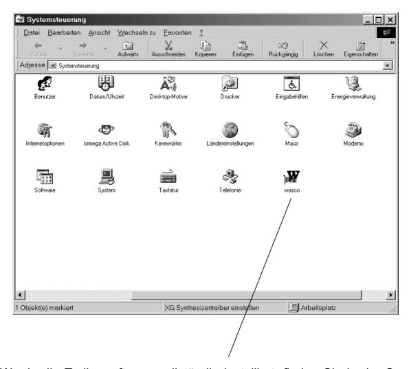
Wurde die Treibersoftware vollständig installiert, finden Sie in der Systemsteuerung Ihres Rechners ein Icon zur Lokalisierung aller im System vorhandenen **wasco**® PCI-Karten.
